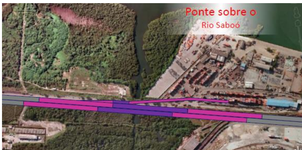
Figura 4.5: Projeto de ponte sobre o rio Saboó com acesso ao terminal.
