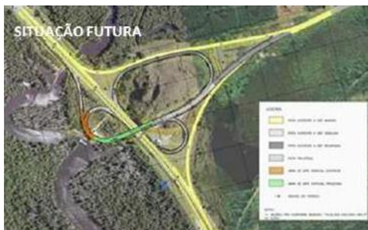
Figura 4.3: Projeto de adequação do trevo da SP-055 com a BR-101 no quilômetro 248.
