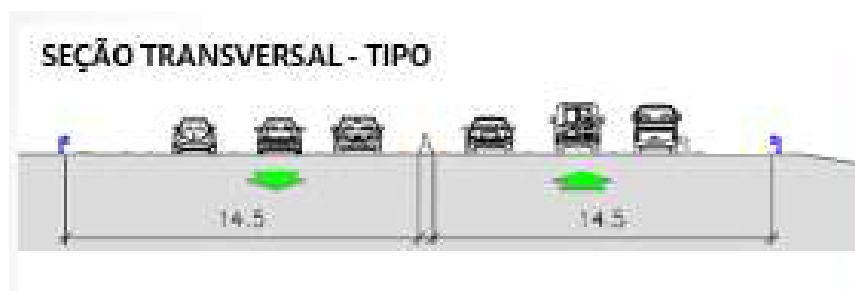
Figura 4.4: Seção transversal de projeto para ampliação da capacidade da Rodovia Cônego Domênico Rangoni, entre quilômetros 262 e 270.
